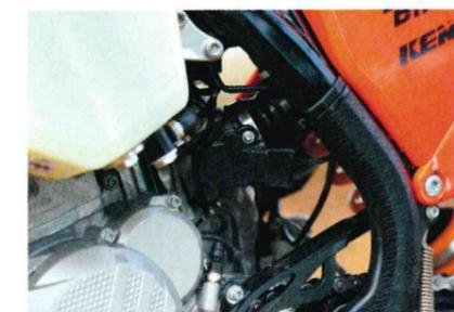
Clapets, venturi, vis de réglage de ralenti et de valve d'échappement du kit Attila viennent modifier le comportement de la 300 Tpi.
